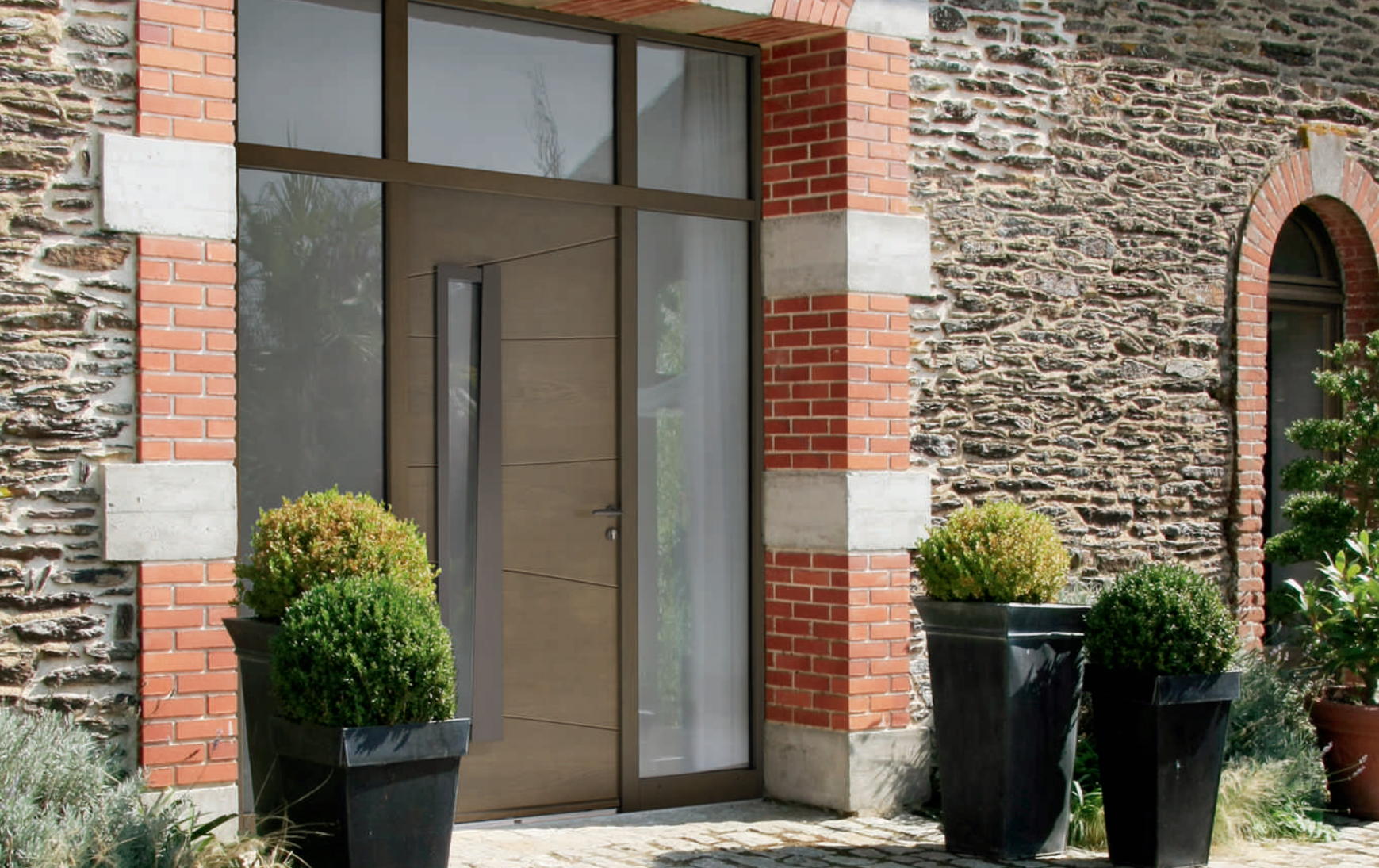
SIGRI CHÊNE LASURÉ MORDORÉ FACE EXTÉRIEURE EN OPTION + 2 FIXES EN DORMANT + IMPOSTE AVEC MENEaux FILANTS - COMPOSITION SUR MESURE H 2750 : OUVRANT 2150 + IMPOSTE 600 - L 2100 : FIXE 600 + OUVRANT 900 + FIXE 600
